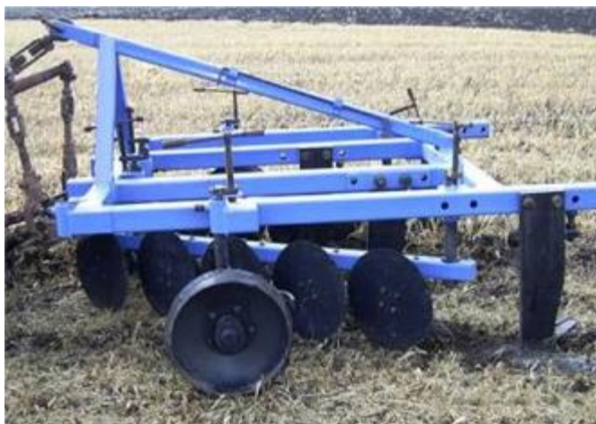
Рисунок 1– Орудие противозерозионное ОП-3С позволяет выполнять поверхностное рыхление на глубину 8-16 см и щелевание до 30 см с одновременным формированием из пожнивных остатков водопоглощающих элементов в виде гребнестерневых кулис. Производительность 2...2,8 га /час.
