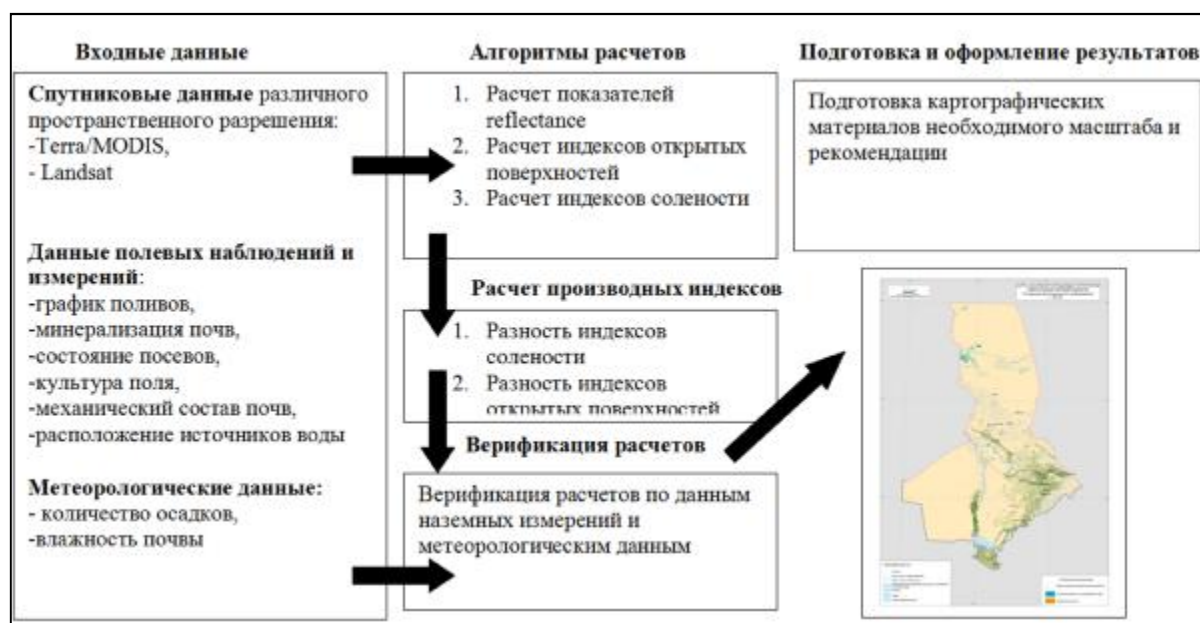
Рисунок 4 - Технологическая схема спутникового мониторинга орошаемых земель
