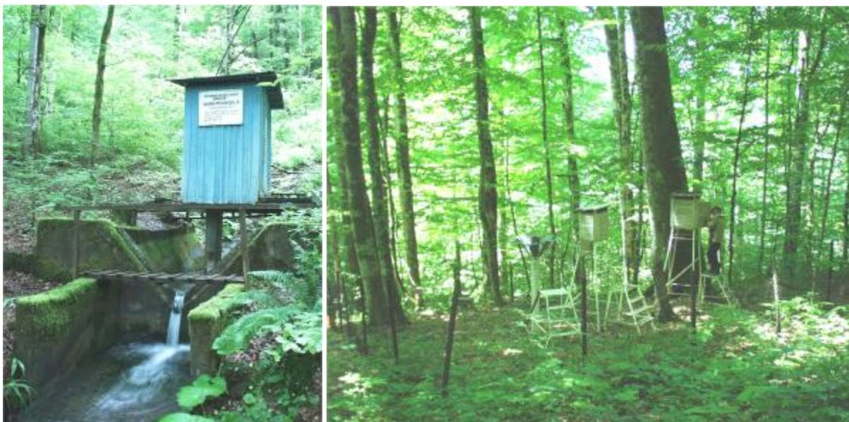
**Фото 2,3.** Изучение склонового стока в буковых насаждениях с помощью водосливного сооружения на лесогидрологическом стационаре «Аибга», Сочинский национальный парк
